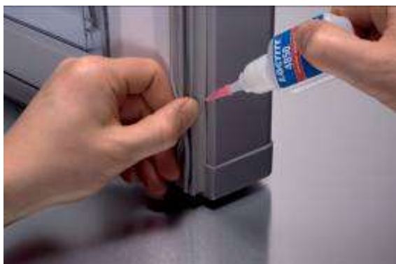
図 2.繰り返し曲げられるパーツ専用 to 考案された高柔軟性シアノアクリレート系接着剤。冷蔵庫ドアにゴムパッキンを接着するなどの用途に使用可能
