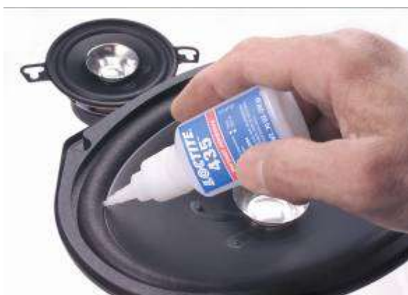
図 1.耐衝撃性を高めた強化タイプの瞬間接着剤。ここではスピーカーのパーツ組立に使用
