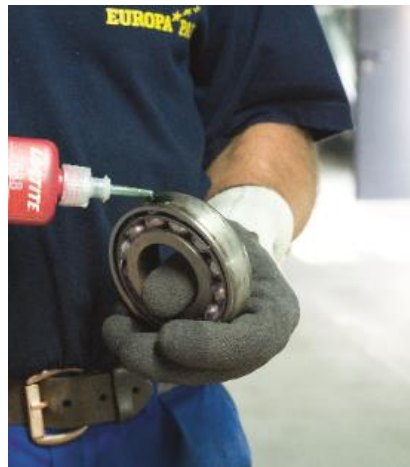
玉軸受ケーシングにロックタイト638を使用してゆるみ止めを施しているところ
