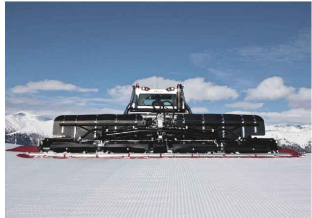
幅7.1メートルの巨大パワーピラー
