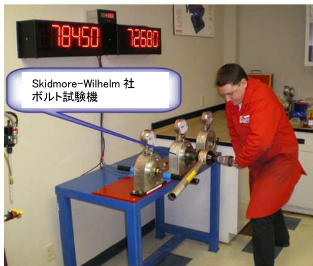
図 4.荷重試験機でボルトにトルクを加える
